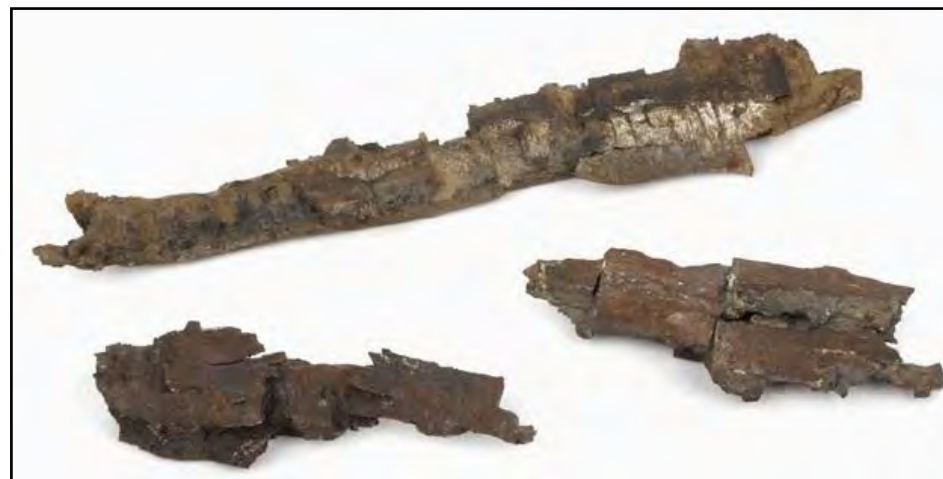
Figuur 25. Scherven afkomstig van een projectiel dat was gevuld met springstof, na detonatie.
