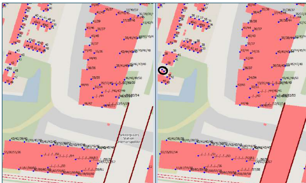
Figuur 9 Geluidsbelasting railverkeer plansituatie 6300 woningen ten westen van de Afrikaweg (links oud model – rechts nieuw model).
