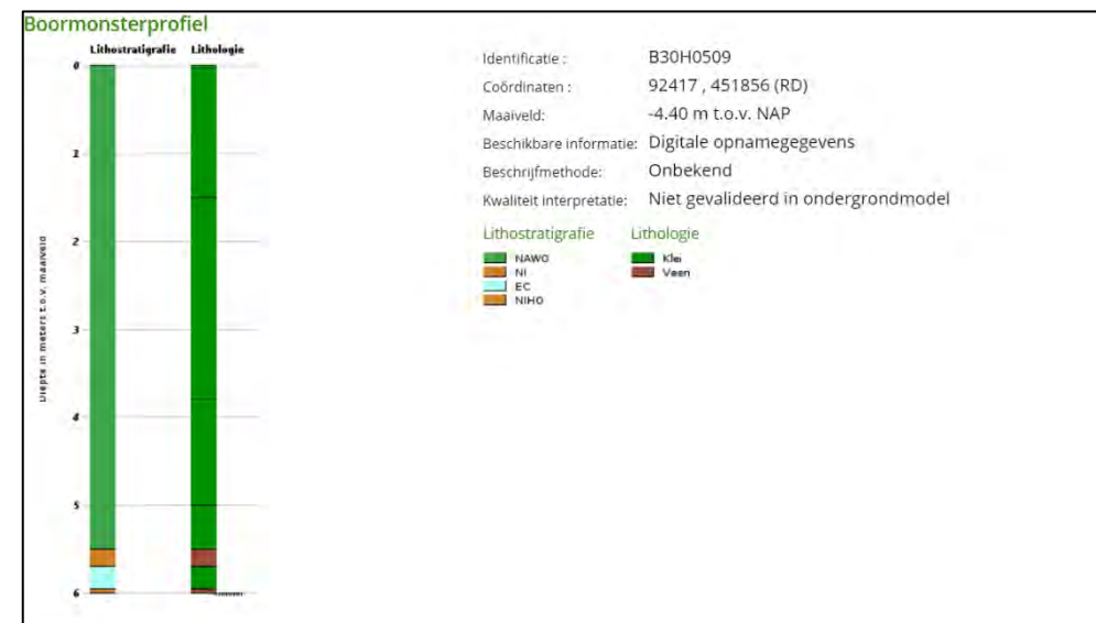
Figuur 23. Boormonsterprofiel van boring B30H0509 (bron: Dinoloket)
